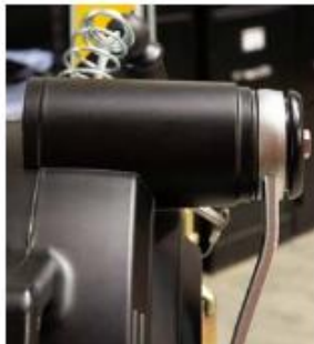
Eje de la manivela adentro en modalidad de rescate o recuperación
